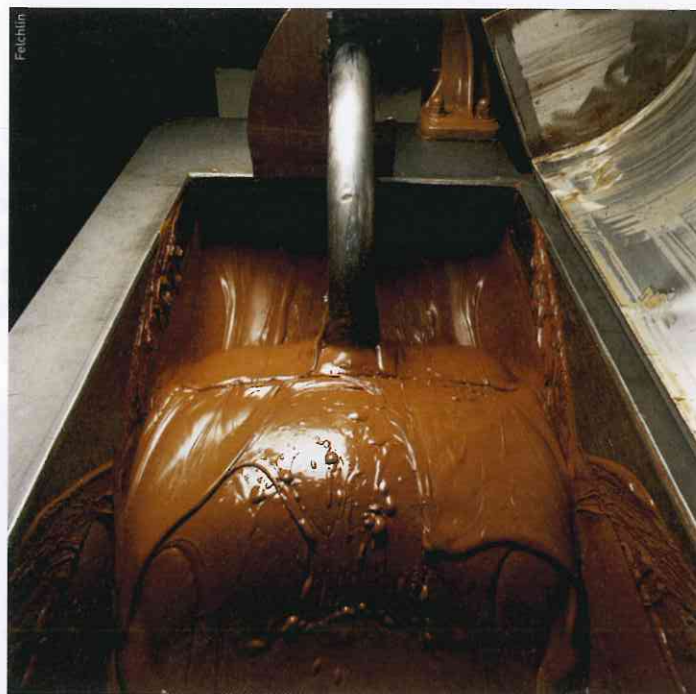
Le conchage permet d'homogénéiser et d'affiner la texture du chocolat.
